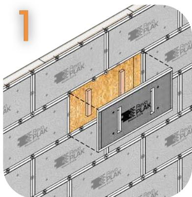
1. Se deberá hacer un calado a la placa de RevoPlak®, hasta llegar a la placa de OSB o placa rigidizadora del muro exterior, en el cual el calado deber ser del espesor de la placa de revestimiento (3cm de RevoPlak).
